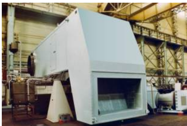
Турбоблок модернизированного агрегата ГТК-10-4 с воздухозаборной камерой и маслоблоком в сборочном цехе предприятия.
