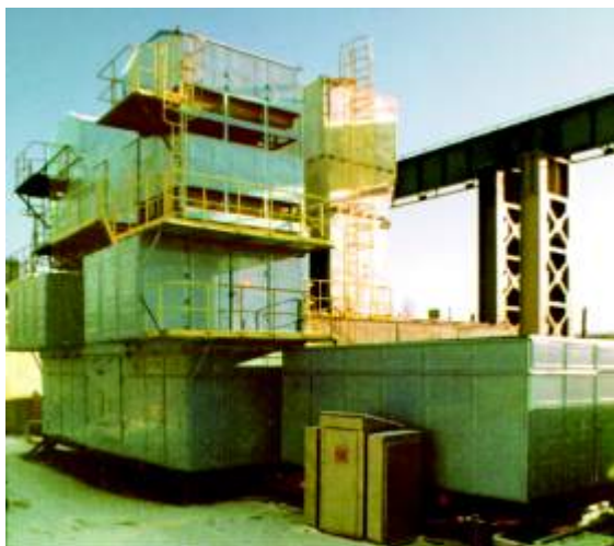
ГПА-Ц-6,3С с газотурбинным двигателем ДТ71
