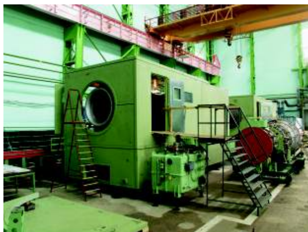
Двигатель ДН80Л с укрытием в сборочном цехе для модернизации агрегата ГПА-25/76
