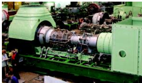
Блок двигателя ДН70Л для модернизации агрегата ГПУ-10 на КС Ромненская, Украина
